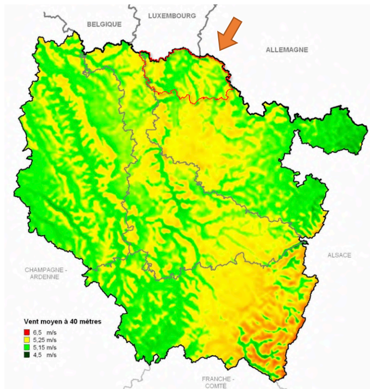
Carte des vents moyens à 40 m en Lorraine (Météo France) (source : Schéma Régional Climat Air Énergie de Lorraine, 2012)
